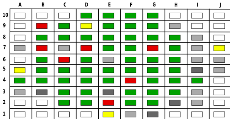
FIGURE 107 – Cartographie du potentiel interne V_{di} de 79 diodes bipolaires du wafer. La signification de la légende est donnée à la figure 4.8. La moyenne est de 3.44 V. L'écart type \sigma est de 0.31 V. Les valeurs MAX et MIN sont respectivement de 4.09 V et de 3.13 V.
