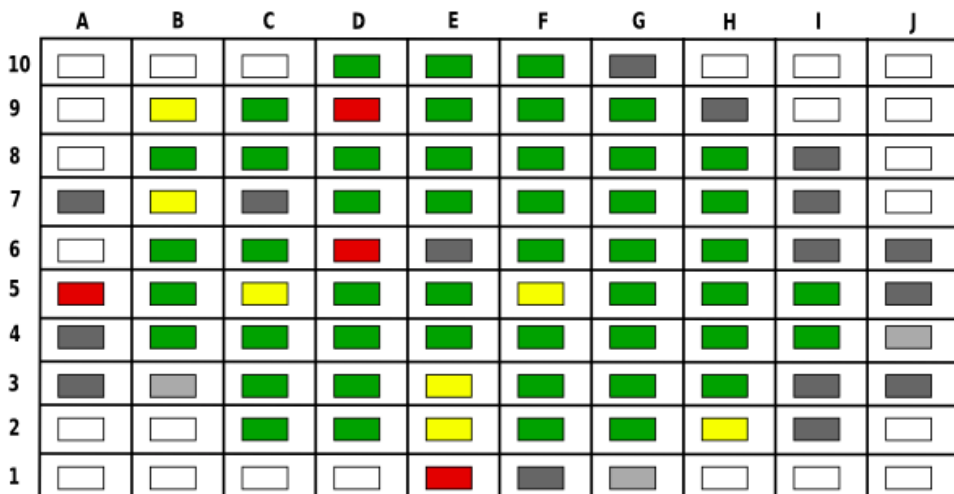
FIGURE 108 – Cartographie de la résistance à l'état passant R_{on}/l pour 79 diodes bipolaires du wafer d'une largeur de jonction l de 6070 \mu\text{m} . La signification de la légende est donnée à la figure 4.8. La moyenne est de 8.89 \Omega/\text{mm} . L'écart type \sigma est de 0.61 \Omega/\text{mm} . Les valeurs MAX et MIN sont respectivement de 10.32 \Omega/\text{mm} et de 7.47 \Omega/\text{mm} .
