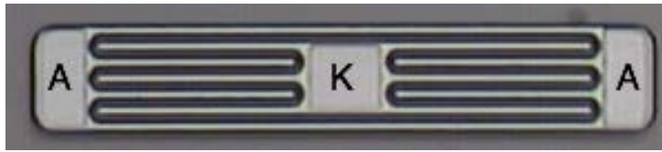
FIGURE 105 – Vue sur le wafer d'une diode bipolaire de largeur de jonction de 6.070 mm. K représente la cathode et A correspond à l'anode.
