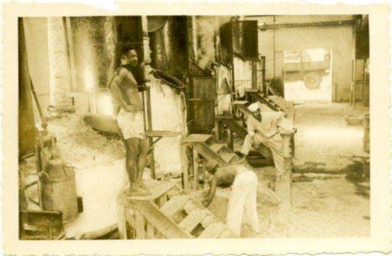
CHARGEMENTS DES FLEURS D'YLANG DANS LES ALAMBICS DE LA DIS- TILLERIE DE BAMBAO.
