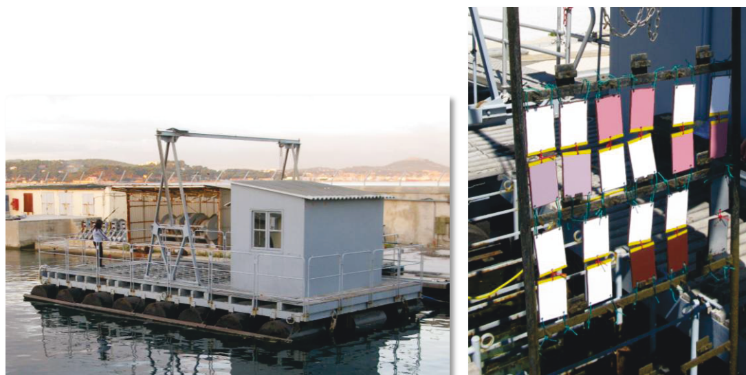
Figure VI-1 : Vue d'ensemble du radeau d'immersion et d'un râtelier sur lequel les plaques de peintures sont disposées.
