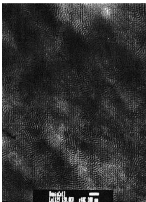
Figure IV-28 : Image MET d'un copolymère greffé pVAc- g -PDMS avec des domaines riches en PDMS dans une matrice de pVAc plus claire. Barre d'échelle = 100nm.
