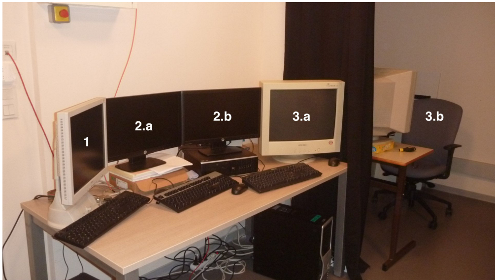
FIGURE 6.2 – Photo de la salle d'expérience composée des différents éléments représentés schématiquement sur la figure 6.1. 5 écrans ont été utilisés dans l'expérience : Un écran de l'ordinateur d'acquisition (1), deux écrans qui affichent les traitements de la grappe de calcul (2.a) et d'OpenViBE (2.b), et un écran qui donne un retour sur la tâche (3.a), un écran pour l'affichage des stimuli au sujet. Le sujet est placé à 60 cm de l'écran (3.b).
