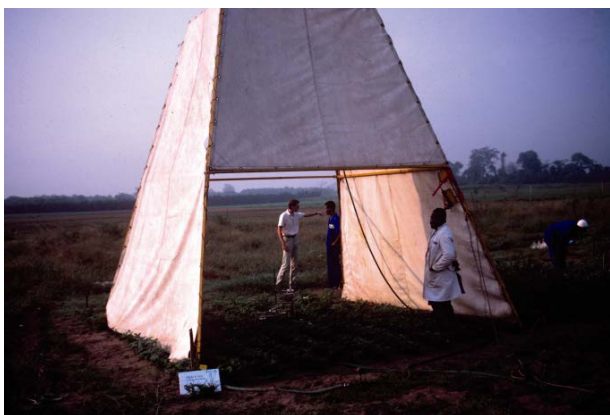
Mini-simulateur de pluie sur champ d'arachide en Côte d'Ivoire.
