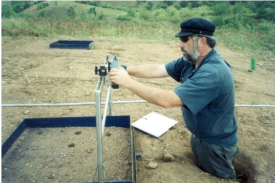
Figure 16. Mesure du nano relief (<5 cm) et du microrelief (<50 cm) à l'aide d'un distanciomètre laser Leica Disto pro.
