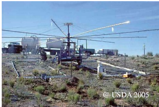
Figure 10. Grands simulateurs de pluie de type Swanson en Arizona.
