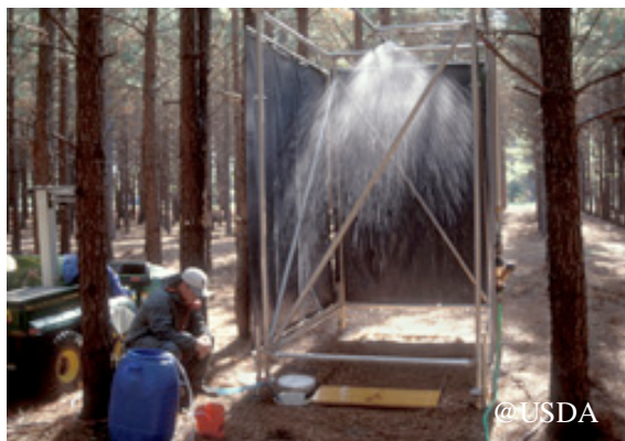
Figure 11. Simulateurs de pluie sur parcelle de 1 m 2 .
