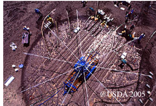
Figure 10. Grands simulateurs de pluie de type Swanson en Arizona.
