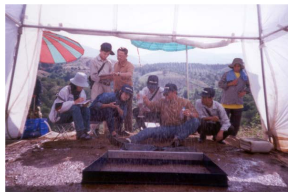
Figure 11. Simulateurs de pluie sur parcelle de 1 m 2 .
