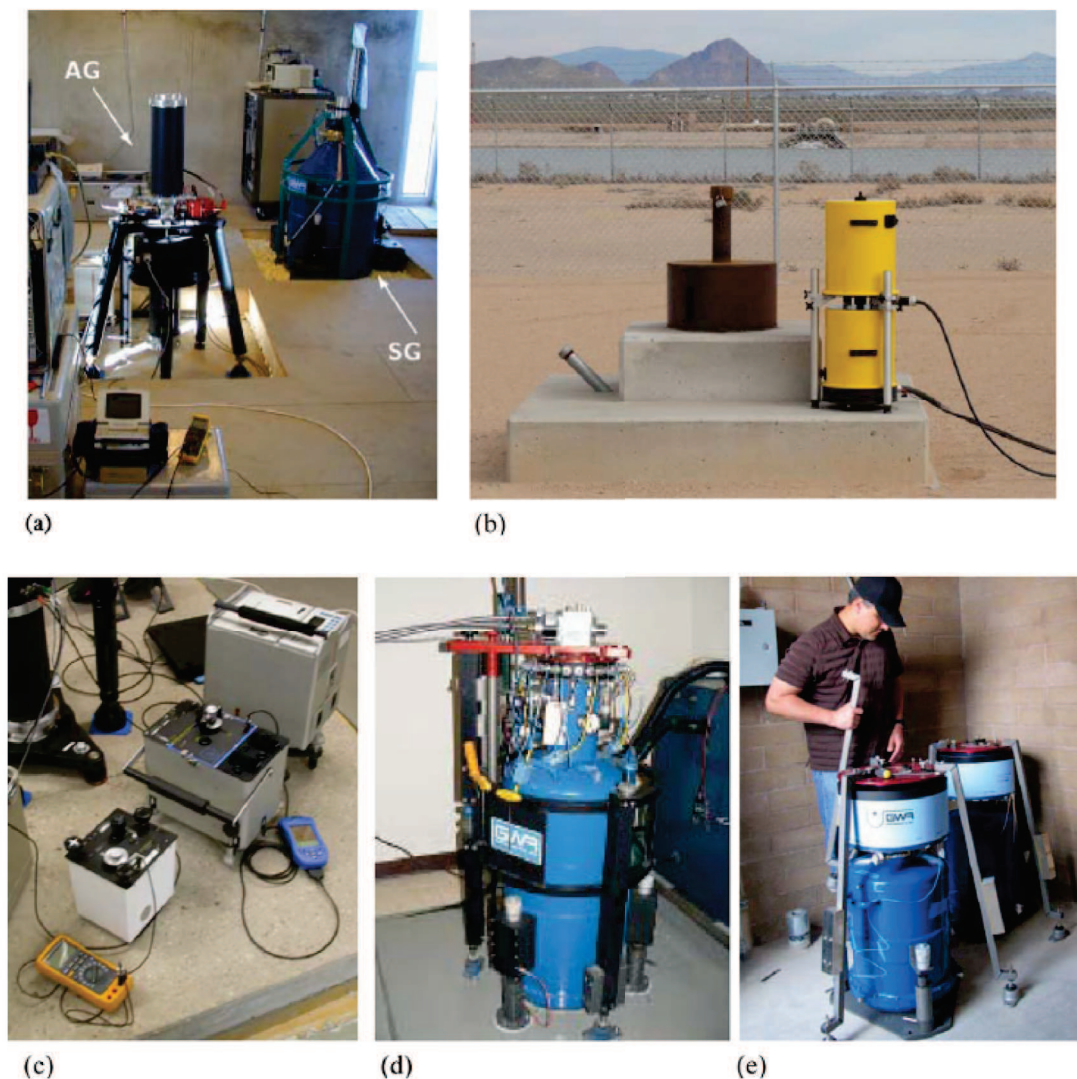
Figure II.1: une sélection de gravimètres : absolus : a) instrument FG5 (AG) et b) A10 ; supraconducteurs : d) OSG et e) deux iGrav ; microgravimètres : c) de gauche à droite : Lacoste & Romberg modèle G, ZLS Burris et Scintrex CG3. D'après Crossley et al. (2013).
