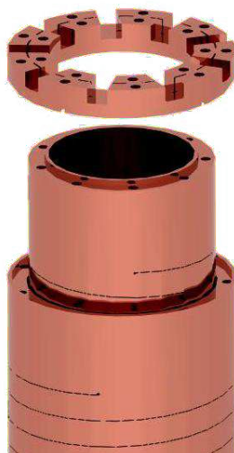
FIGURE 10.1 – Un insert poly-hélices. Les hélices sont des tubes en alliage de cuivre découpés par une technique d'érosion. La colle époxy peut être introduite dans la fente pour assurer l'isolation électrique entre les spires : il s'agit d'hélices à refroidissement longitudinal, car le débit d'eau est longitudinal. Une autre possibilité pour assurer cette isolation consiste à introduire périodiquement des isolants dans la fente : on parle alors d'hélices à refroidissement radial, puisque l'eau s'écoule à partir de l'intérieur vers l'extérieur de la fente ouverte.
