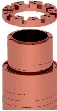
FIGURE 10.1 – Un insert poly-hélices. Les hélices sont des tubes en alliage de cuivre découpés par une technique d'érosion. La colle époxy peut être introduite dans la fente pour assurer l'isolation électrique entre les spires : il s'agit d'hélices à refroidissement longitudinal, car le débit d'eau est longitudinal. Une autre possibilité pour assurer cette isolation électrique entre les spires consiste à introduire périodiquement des isolants dans la fente : on parle alors d'hélices à refroidissement radial, puisque l'eau s'écoule à partir de l'intérieur vers l'extérieur de la fente ouverte.
