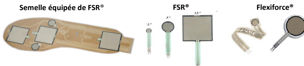
Figure 55. Semelle équipée de capteurs FSR® [163], capteurs FSR® et Flexiforce®
