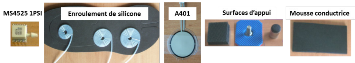
Figure 60. Surfaces d'appui, capteurs et enroulements de silicone (tests statiques)
