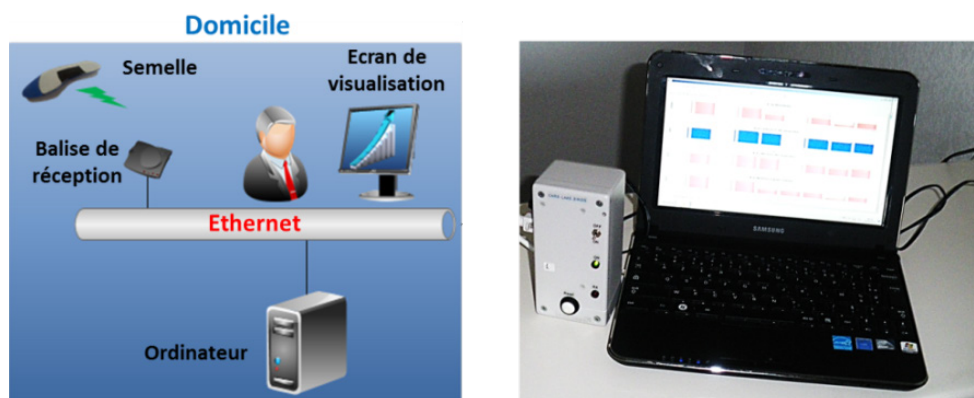
Figure 82. Architecture système installée à domicile
