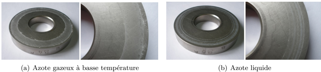
Figure 3.10 - Photographies de pistes en acier X105CrMo17 après essais en azote gazeux à basse température et azote liquide
