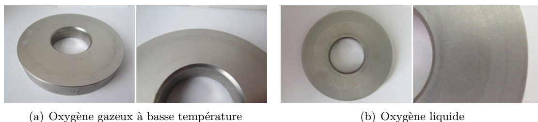
Figure 3.12 - Photographies de pistes en acier X105CrMo17 après essais en oxygène gazeux à basse température et oxygène liquide
