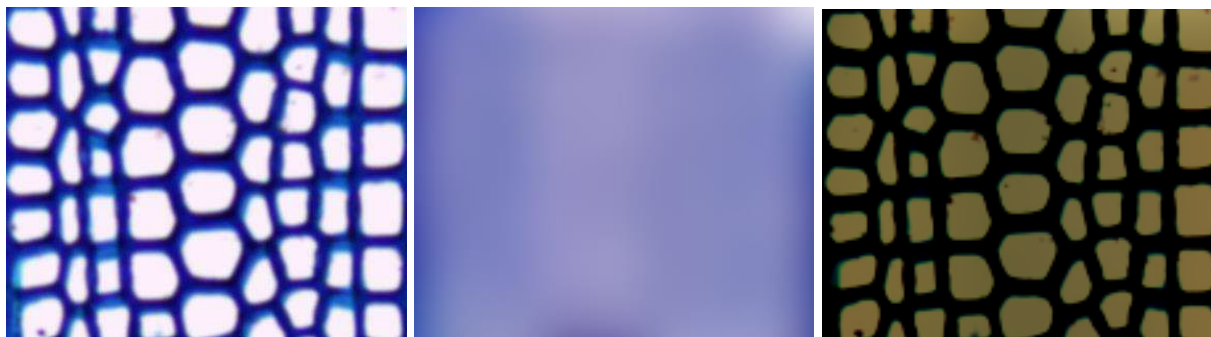
Figure 15. Rehaussement du contraste de l'image par la méthode de Différence de Gaussiennes (DoG). A gauche l'image résultante d'un faible DoG ( \sigma = 3 pixels). Au centre, l'image résultante d'un fort DoG ( \sigma = (\text{largeur image})/10 ). A droite, la soustraction des images A et B qui augmente le contraste lumen/paroi. La valeur de l'intensité des pixels de la paroi est nulle.
