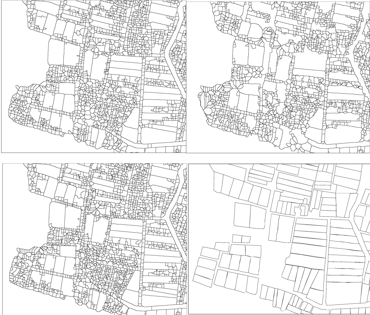
Figure 46. Lignes de crête respectivement obtenues à partir des images RGB (en haut à gauche), RedNirPan (en haut à droite) & RedNir (en bas à gauche). Quelques différences sont observables mais globalement, le résultat est largement sur-segmenté par rapport à l'image de référence (en bas à droite)
