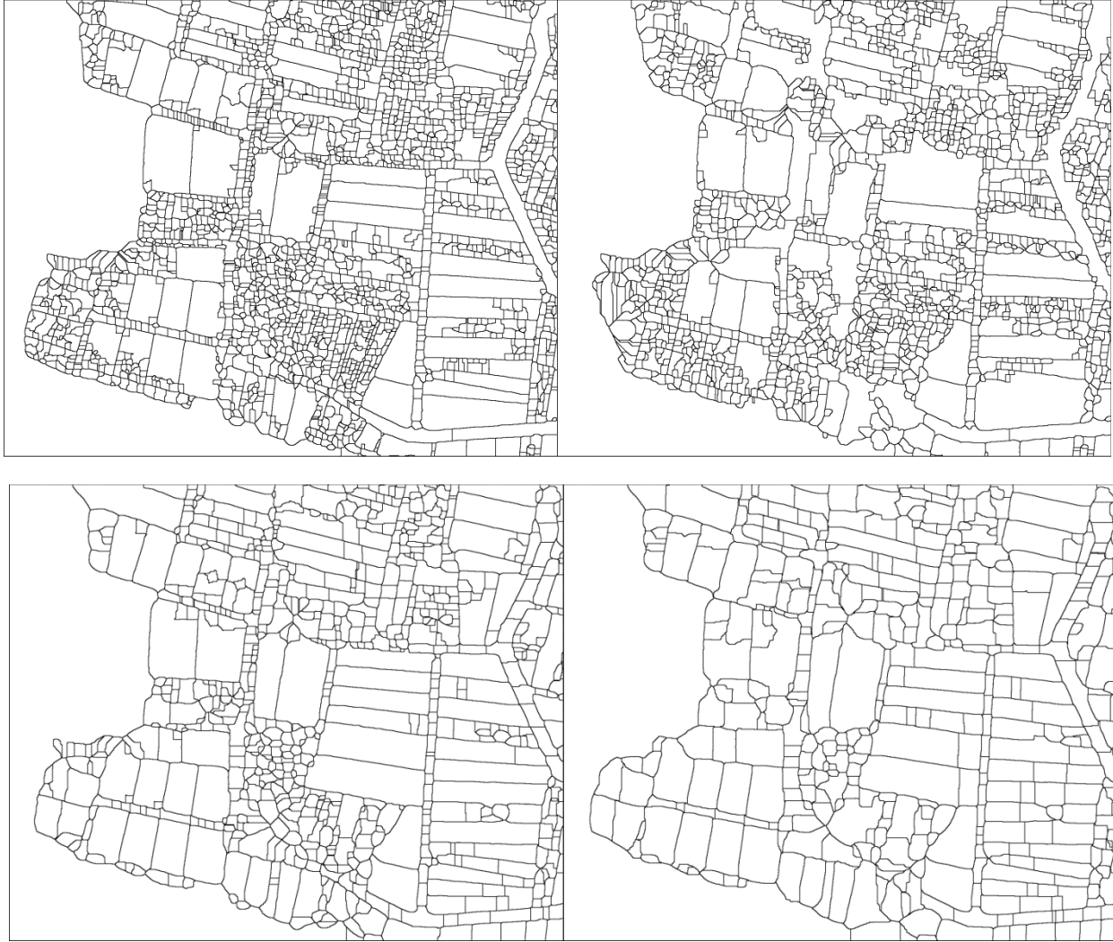
Figure 48. Variation arbitraire (0, 3, 6 et 10) de la valeur du flou minimal lors du DoG, avant l'application du watershed sur l'image RedNirPan
