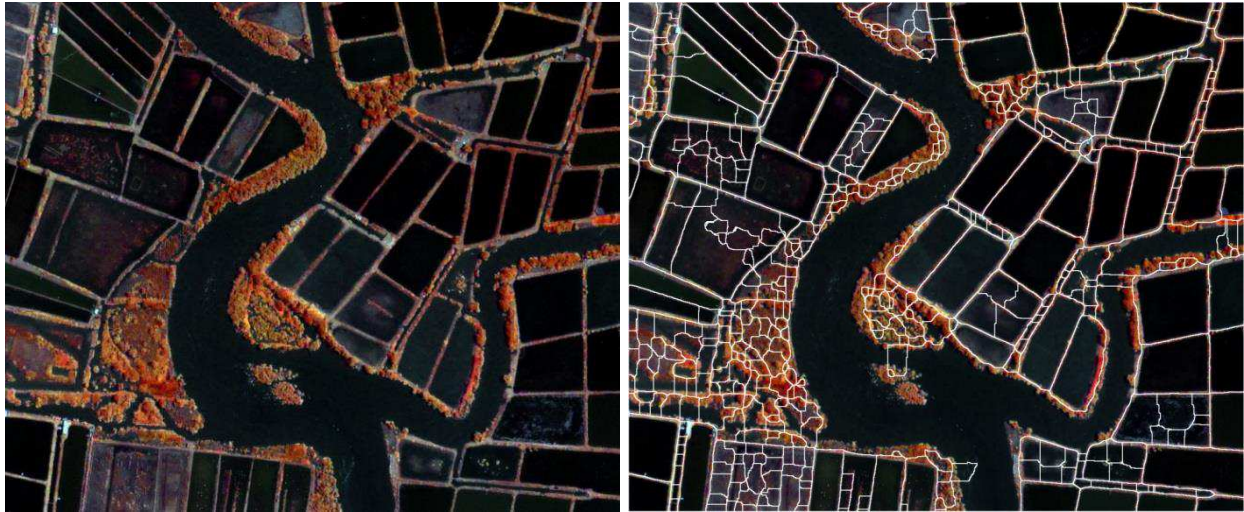
Figure 44. Segmentation automatique d'une image satellitaire de champs de crevettes. A gauche, l'image native, la rivière au centre de l'image a déjà été filtrée par l'opérateur. A droite, le résultat de la segmentation en surimpression. Certains champs sont bien segmentés, mais on observe une sursegmentation assez importante pour les zones texturées.
