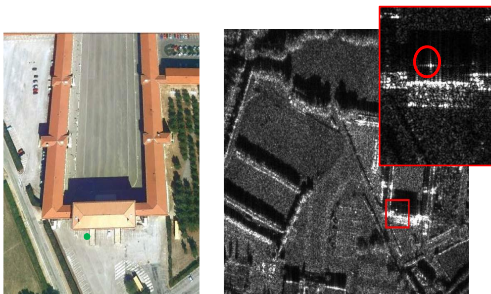
Figure B.1: (Gauche) Bâtiment d'étude avec une cible (cornet réflecteur) située en face (le point vert indique la position de la cible). (Droite) Image SAR correspondante acquise et traitée par l'ONERA durant une campagne de mesures impliquant la plate-forme moteur Busard équipé d'un radar routier. La bande de fréquences est de [33-37] GHz, et l'angle d'incidence est de 60^\circ . Cette image contient un artefact: la cible située initialement en face de l'immeuble est synthétisée à la zone d'ombre située derrière le bâtiment (voir le rectangle rouge).
