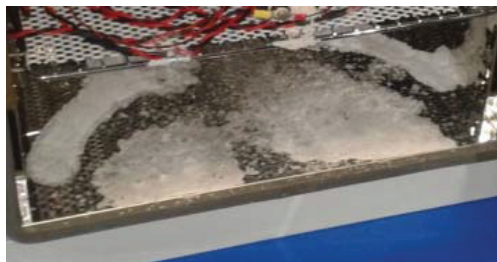
Figure 4.23 Fuite d'électrolyte lors des vieillissements CA court et CA long des supercondensateurs du fabricant C sur la paroi inférieure de l'enceinte thermique
