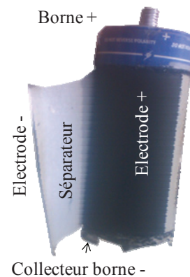
Figure 1.13 Bobinage des constituants du supercondensateur
