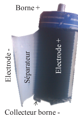
Figure 1.13 Bobinage des constituants du supercondensateur
