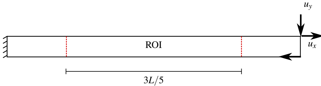
FIGURE 3.11 – Zone réanalysée de la poutre en flexion parabolique
