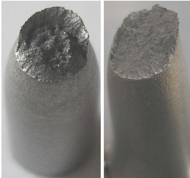
Figure II.11 : Profils de rupture des éprouvettes de traction à 20°C et à 200°C.
