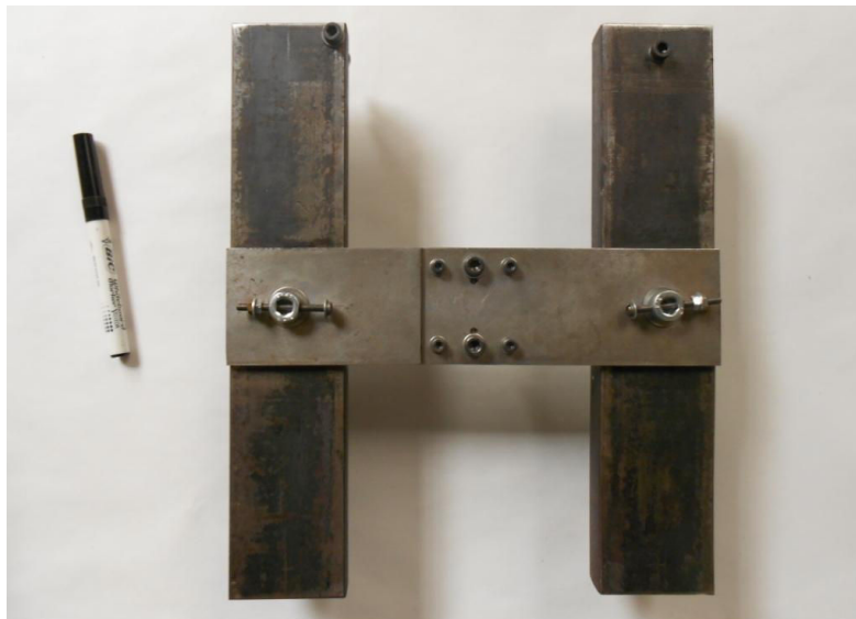
Figure 5.15 – Banc d'essai lap-joint en H.
