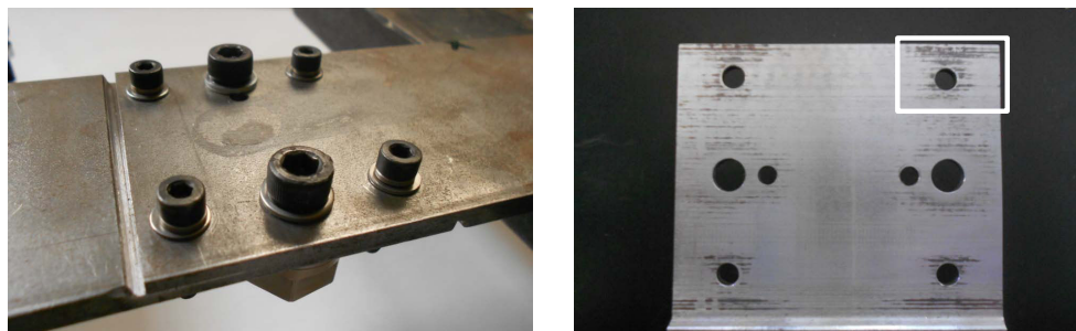
Figure 1.1 – Usure caractéristique d'une interface de contact signifiant la dissipation d'énergie par frottement.
