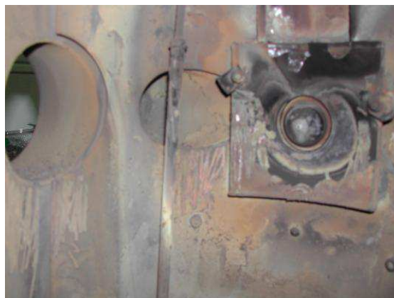
FIGURE 5.6 – Intérieur de la chambre source de “Nanograins” où l’on aperçoit des zones de “ramonage” des suies à gauche du cône.
