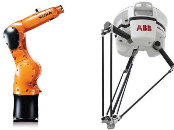
FIGURE 3.8 – Deux solutions architecturales classiques : robot KR 6 R700 SIXX (KR AGILUS) de Kuka à gauche, robot IRB 360 FlexPicker de ABB à droite.
