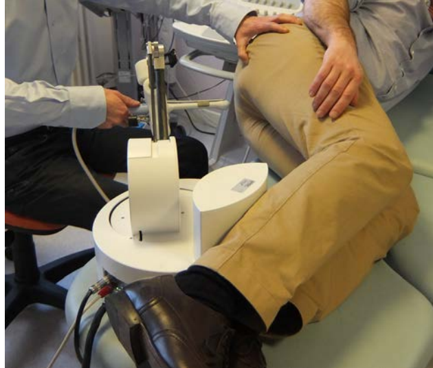
FIGURE 2.5 – Exemple de positionnement du robot Apollo pour la réalisation de biopsies prostatiques
