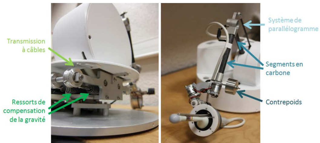
FIGURE 2.11 – Éléments mécaniques améliorant la transparence du robot Apollo.
