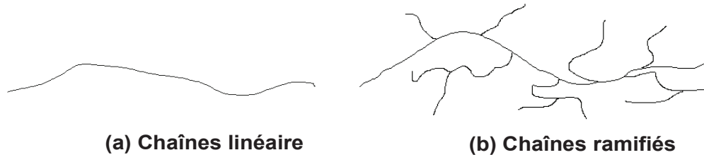
Figure A2.2. Structure de chaînes moléculaires : a) linéaires, b) ramifiées.
