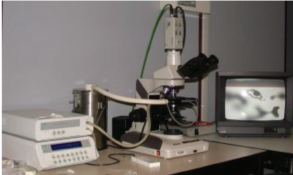
Figure 1. Platine chauffante/réfrigérante Linkam Inc. THM 600 couplée à un microscope optique pour les mesures microthermométriques.
