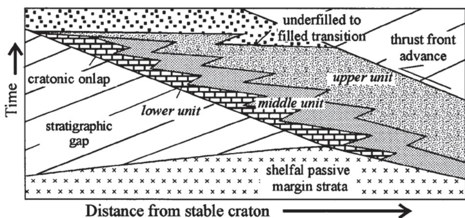
Figure 2-6. Représentation chronostratigraphique des unités composant la phase « **underfilled** » de remplissage de bassin d'avant-pays. Ces unités sont diachrones en réponse à la migration de la subsidence dans le bassin (d'après Sinclair, 1997a).
