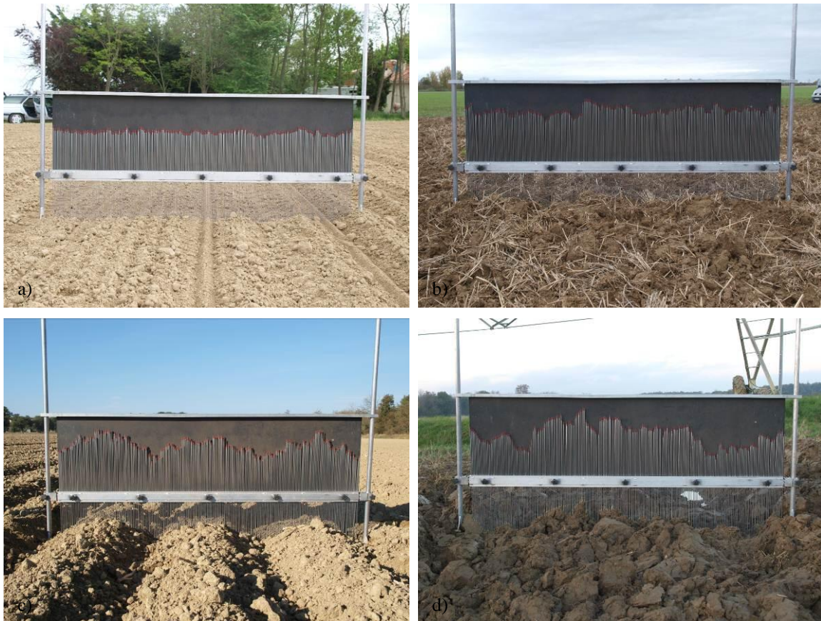
Figure 41 : Photographies du rugosimètre à aiguille réalisées sur quatre états de rugosité : préparé motteux a), déchaumé b), travaillé c), et labouré d).
