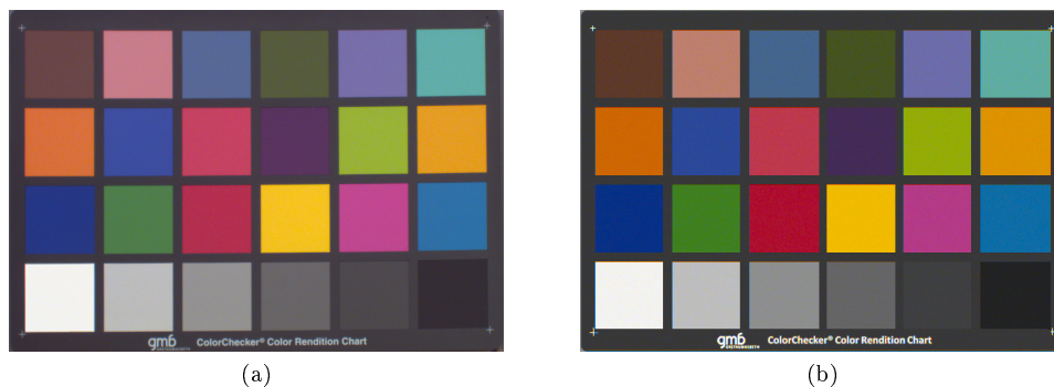
FIGURE 3.21 – Mire de Macbeth pour un éclairage de scène de 2000lux sous 3200K après reconstruction couleur sur (a) une image mesurée, (b) une image simulée.
