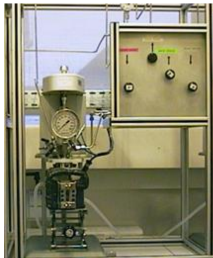
Figure V-14 Réacteur batch utilisé pour la mesure des solubilités
