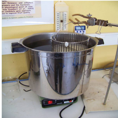
Figure 31. Dispositif expérimental pour le lessivage des échantillons
