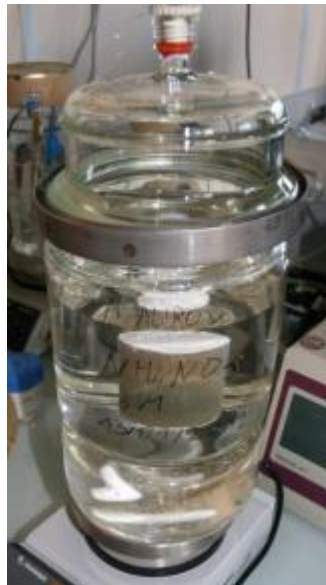
Figure 148 : Dispositif de l'essai LECBA - Lixiviation d'une pâte de ciment dans une solution de \text{NH}_4\text{NO}_3 (6M) à 25°C.
