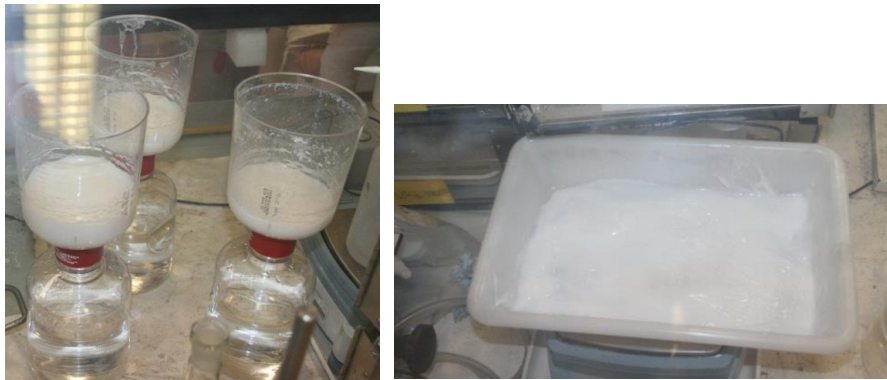
Figure 164 : Synthèse d'ettringite en boîte à gants.
