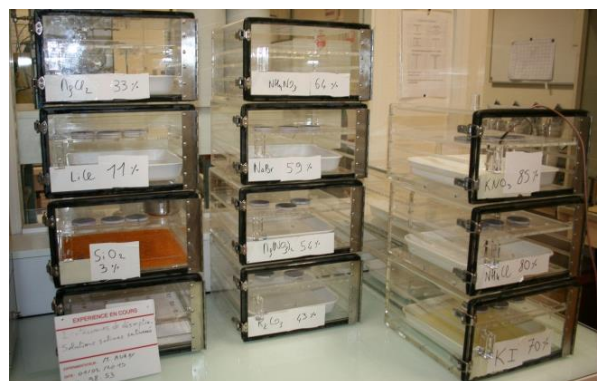
Figure 49 : Enceintes de dessiccation utilisées pour l'acquisition des isothermes de sorption en salle climatisée à 20°C ± 2°C.
