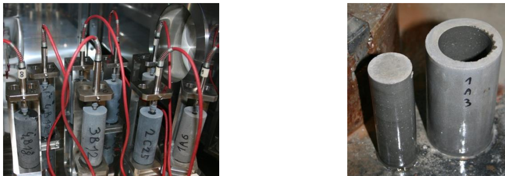
Figure 48 : Mise en place des cellules de mesure de retrait en enceinte (HR = 55%, 25°C).
