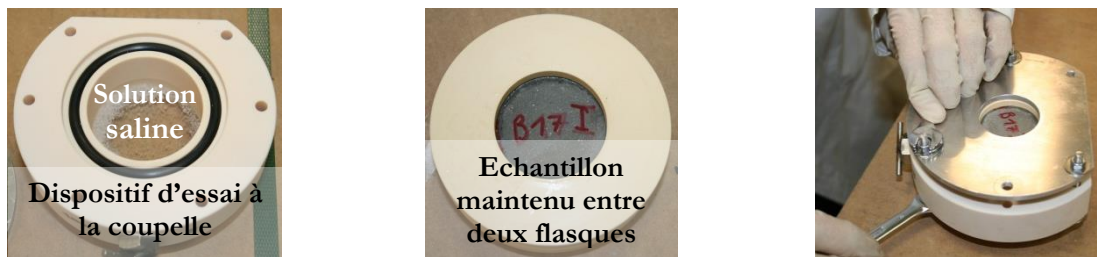
Figure 59 : Photographies de la partie intérieure du dispositif d'essai à la coupelle, de mise en place de l'échantillon et du dispositif final.
