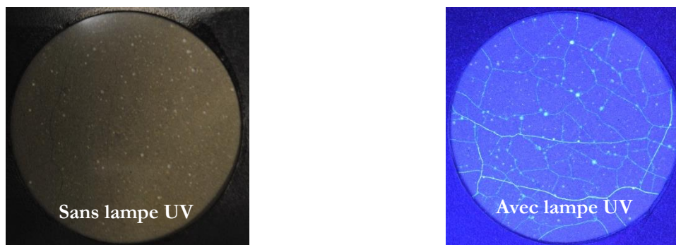
Figure 47 : Imprégnation d'un échantillon PI après un essai de carbonatation accélérée à P_{CO_2} \approx 3\% (25°C, HR = 55%) durant 349 jours et observation sous lampe UV.
