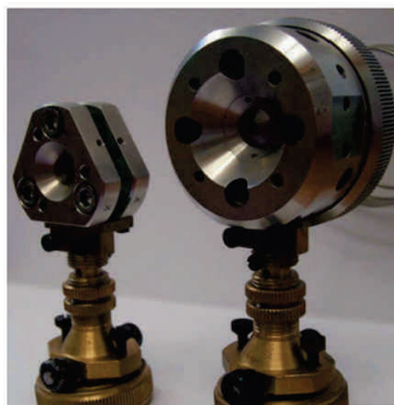
FIGURE 2.17 – à gauche : Presse à vis et à droite : presse à membranes utilisées lors de l'expérience sur ID09
