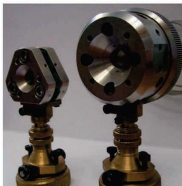
FIGURE 2.17 – à gauche : Presse à vis et à droite : presse à membranes utilisées lors de l'expérience sur ID09
