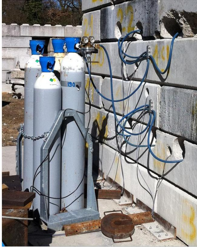
**Figure 57 : photo des réservoirs d'oxygène sous pression**
