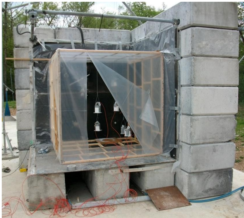
Figure C.F3 : photo du montage expérimental avec le dispositif de dispersion pyrotechnique
