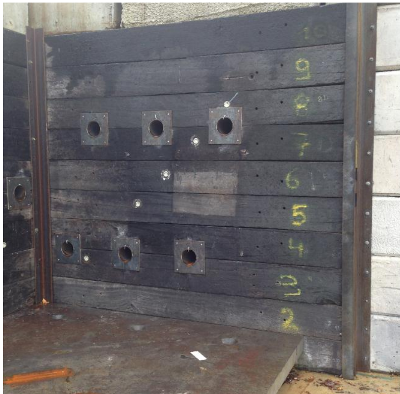
Figure 56 : implantation des cylindres dans la paroi droite du montage expérimental
