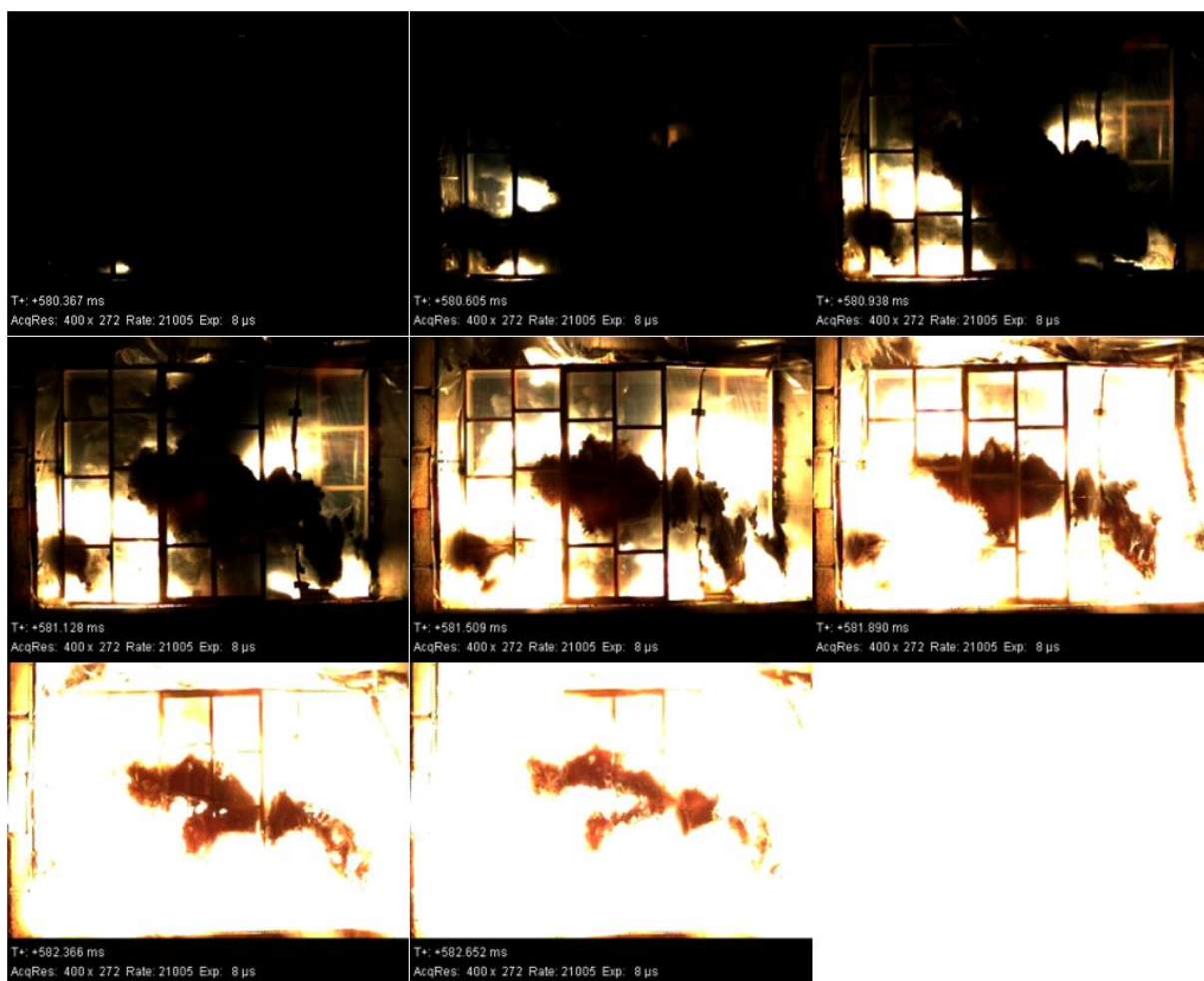
Figure C.F6 : expérience de dispersion et tentative d'amorçage d'une onde de détonation
