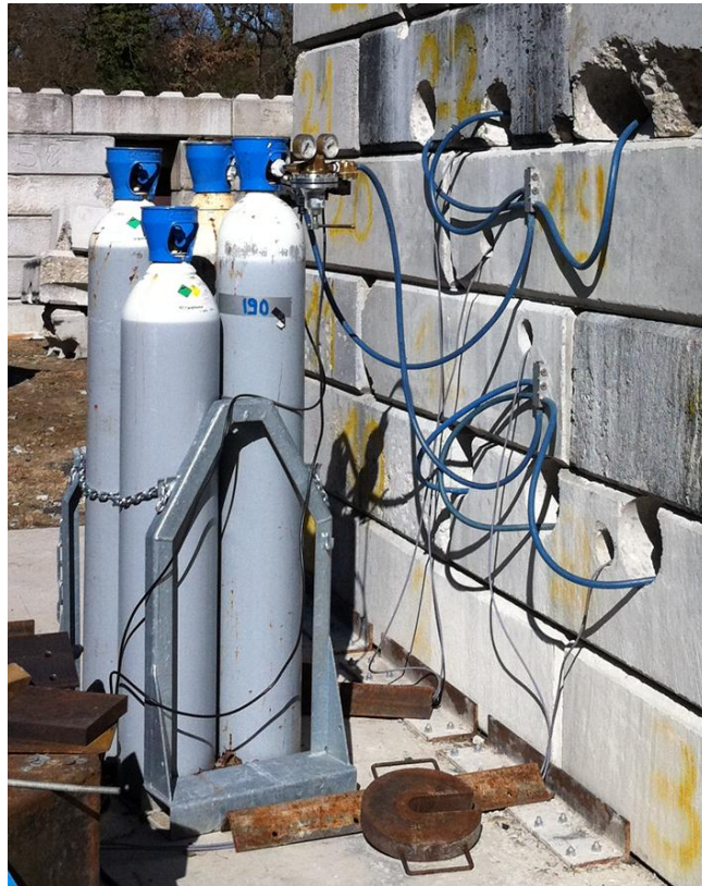
Figure C.F11 : photo des réservoirs d'oxygène sous pression
