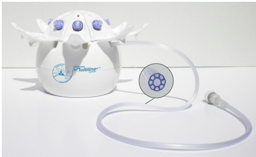
Figure 34. Edelvaiss Multiline-8 de Doran International, Toussieu-Lyon, France. Dispositif d'administration 8 voies à valves unidirectionnelles pour l'administration IV jusqu'à 8 principes actifs simultanés et sans mélange. 1 voie haut débit signalée par l'icône HF (High Flow). Longueur tube multivoies en PVC DINCH (sans phtalates, sans DEHP) = 150 cm. Volume interne : 7 voies à 0,9 mL, 1 voie HF à 2,9 mL. Utilisable pendant 7 jours. Existe en version 3 et 5 voies.
