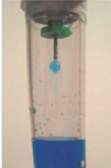
**Figure 7.** Formation d'une goutte dans une chambre compte-gouttes. Le liquide a été coloré pour mieux visualiser le phénomène [Pierce ET, Kumar V, Zheng H, Peterfreund RA. Medication and volume delivery by gravity-driven micro-drip intravenous infusion: potential variations during "wide-open" flow. *Anesth Analg.* 2013;116(3):614-8].
