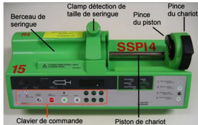
Figure 15. Divers éléments composant un pousse-seringue [Cours IFSI. Les pousse-seringues électriques. 2011].
