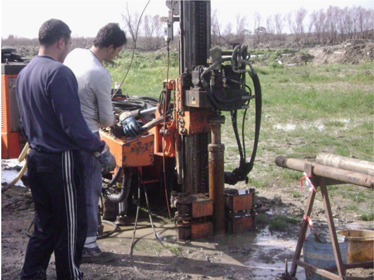
Figure 2.2 : Prélèvement de séquences sédimentaires à l'aide d'un carottier mécanique rotatif (petit carottier à chenilles).
