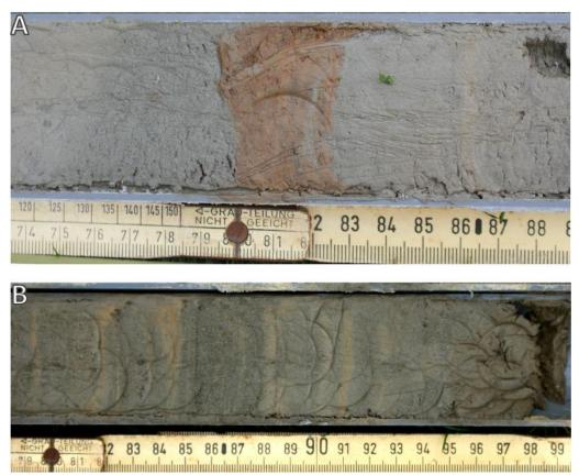
Figure 4.10 : Photographies des laminations (A) ocres (989-1000 cm) et (B) beiges (679-700 cm) présentes dans les unités B et C de la carotte EPH 276.
