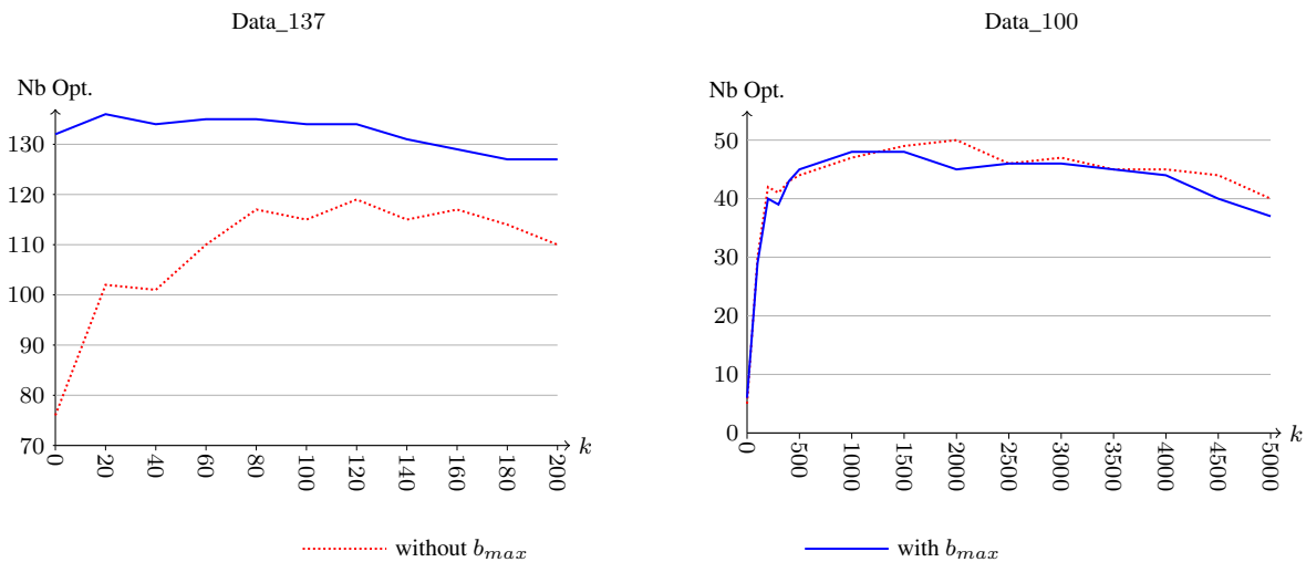
FIGURE 7.10 – Nombre d’instances résolues à l’optimum par \uparrow\text{AMNV}\langle G_{CZ}|\text{MD}, \mathbb{R}^k|\mathcal{R}_{1,3}\rangle en moins de 5 minutes, selon différentes valeurs de k , avec et sans l’ajout de la variable b_{max} pour réifier la contrainte \text{MAX}(\mathcal{X}) = N .
