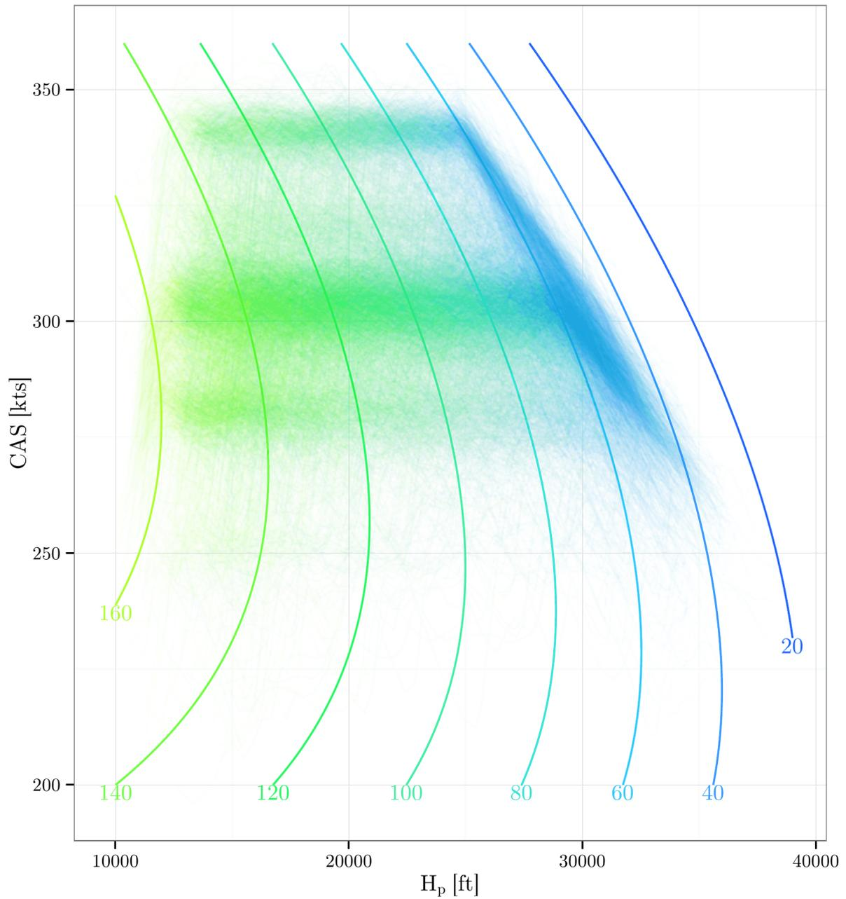
FIGURE 4.18 – On a tracé des isolignes d’excès de puissance spécifique (SEP) correspondant à la modélisation BADA. Pour les trajectoires Mode-C, les valeurs de SER sont représentées par le biais d’un dégradé de couleurs pour les isolignes et les trajectoires. La correspondance entre les couleurs et les valeurs peut être lues sur les isolignes en W/kg.
