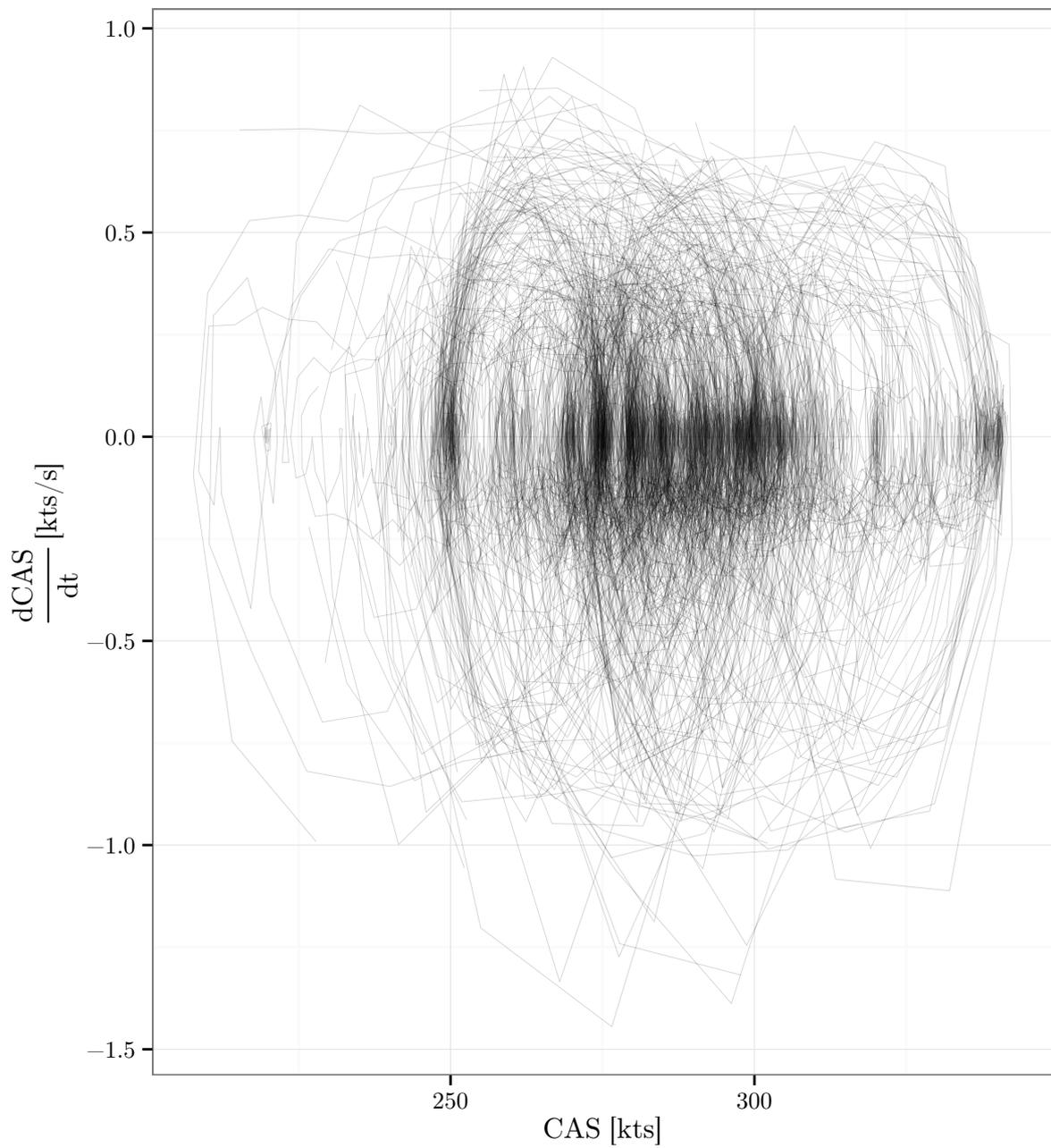
FIGURE 4.17 – Pour les trajectoires Mode-S, ce graphique représente l'accélération en fonction de la vitesse. On a pris les trajectoires dont l'erreur sur la TAS après ajustement d'un profil ( $CAS_{cible}, Mach_{cible}$ ) fait partie des 25% les plus élevées et on a uniquement représenté les points d'altitude supérieur à  $H_{p0}$ .
