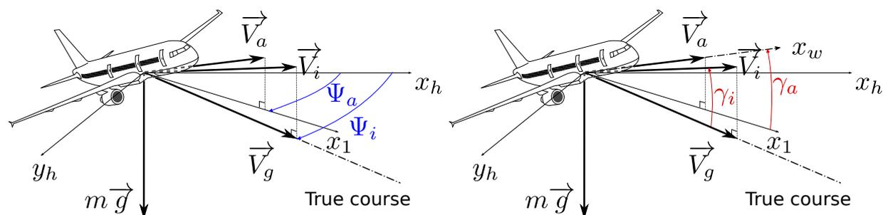
FIGURE 2.2 – Cette figure fait apparaître la vitesse inertielle  $\vec{V}_i$ , la vitesse dans l'air  $\vec{V}_a$ , la vitesse inertielle dans le plan horizontal  $\vec{V}_g$ , le cap  $\Psi_a$ , la route  $\Psi_i$ , la pente  $\gamma_i$  et la pente dans la masse d'air  $\gamma_a$  (avec  $x_h$  pointant le nord).
