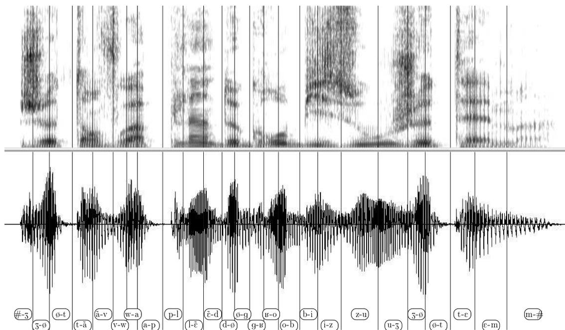
FIGURE 9 – Segmentation en diphones de la phrase « *Je t'envoie plein de gros bisous je t'aime* ». La partie inférieure correspond à la forme d'onde et la partie supérieure au spectrogramme. On peut y distinguer les parties stables du signal sur lesquelles sont placées les frontières de diphones.
