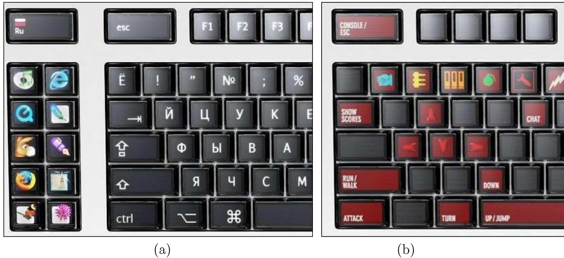
Figure 37 : Photos du clavier Optimus Maximus . (a) La clavier avec l'ordre des touches Russe. (b) Le clavier configuré pour le jeu vidéo de tir subjectif Quake de l'éditeur id Software .
