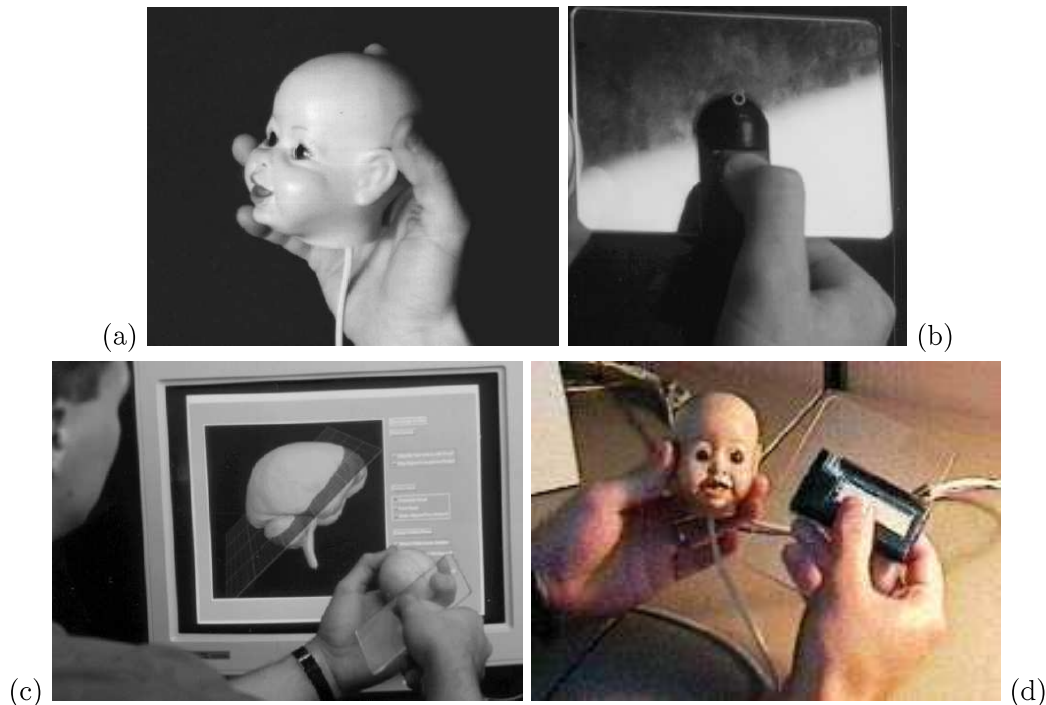
Figure 33 : Photos des Passive Props pour la neurochirurgie [Hinckley 94]. (a) La tête de poupée. (b) La plaque rectangulaire équipée d'un bouton. (c) Le système en action. (d) La plaque rectangulaire est équipée d'un bouton membrane.
