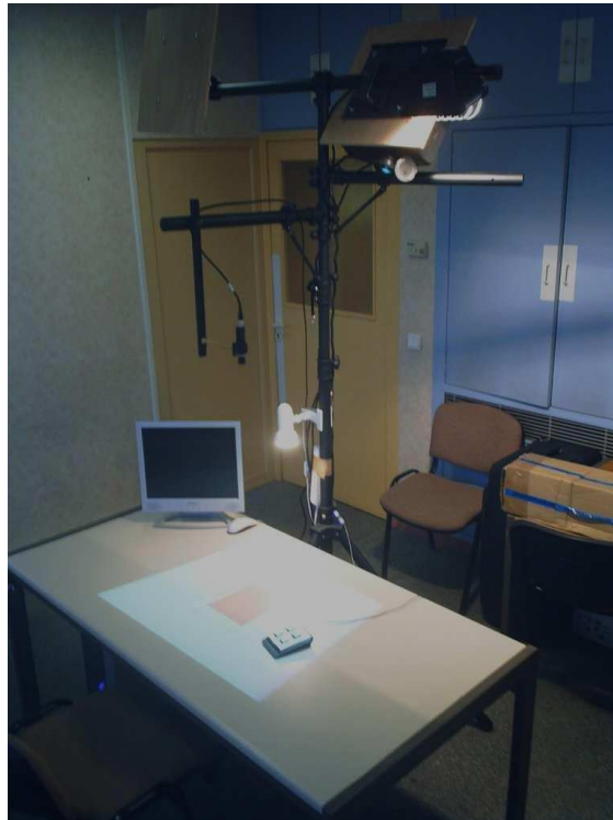
Figure 30 : L'interface utilisateur GeoTUI installée à l'IFP [ www.ifp.fr ] pour l'étude formelle conduite le 6 mars 2007. La configuration matérielle de GeoTUI utilise une table, un vidéo-projecteur et une caméra montés sur trépied.
