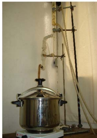
Figure 29 : Autocuiseur adapté pour extraire l'huile essentielle par entraînement à la vapeur (cliché de l'auteur)
