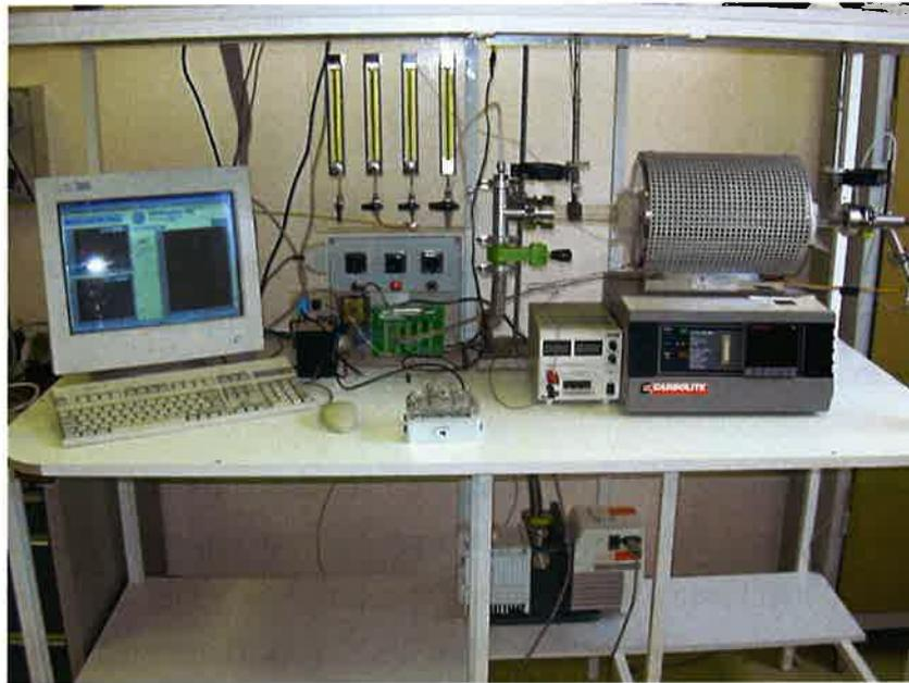
Figure 31 : Banc de mesure de conductivité électrique
