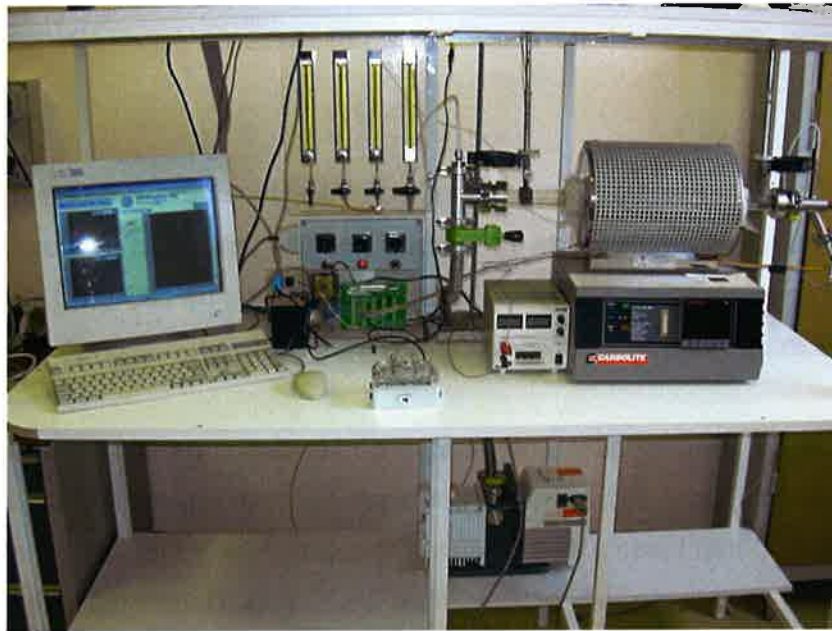
Figure 31 : Banc de mesure de conductivité électrique
