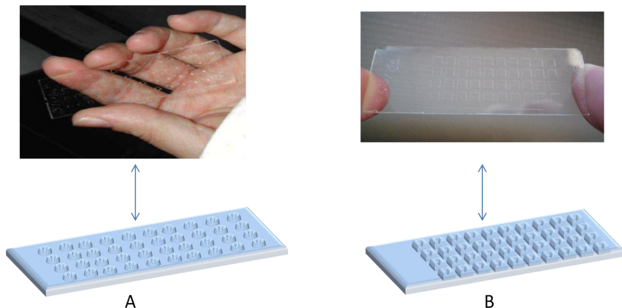
Figure 2-2 Photo et schéma de la biopuce (glycoarray). A) Lamme de verre microstructurée avec 52 microréacteurs ronds (2mm de diamètre) ou B) microstructurée avec 40 microréacteurs carrés (3mm de côté).
