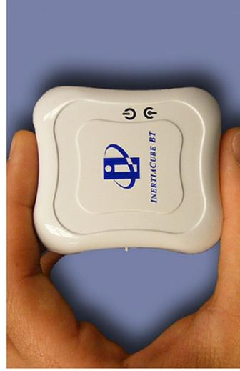
FIGURE 3.10 – Capteur InertiaCube BT [Inc.10]
