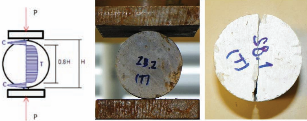
Figure 3-10 Schéma d'essai brésilien, mise en place du dispositif et éprouvette après essai
