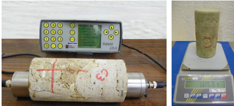
Figure 3-5 Mesure de la vitesse sonique et pesage d'une éprouvette
