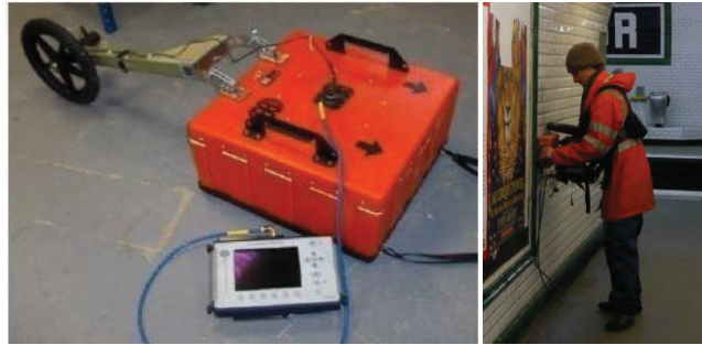
Figure 2-8 Antenne géoradar et réalisation d'un essai sur tunnel
