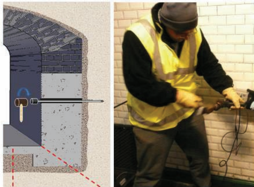
Figure 2-16 Schéma d'implantation d'un essai Panda (gauche), et réalisation in situ (droite)
