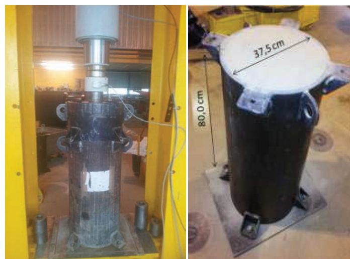
Figure 4-11 Réalisation de l'essai dans le moule de calibration
