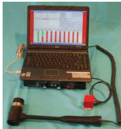
Figure 2-2 Dispositif général essai d'impédance (GI, 2010)
