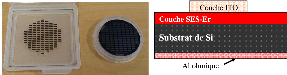
Figure V.14 : (a) : Image du masque utilisé pour déposer la couche d'ITO sur la couche SES-Er. (b) : Schéma de la structure obtenue après le dépôt d'électrodes.
