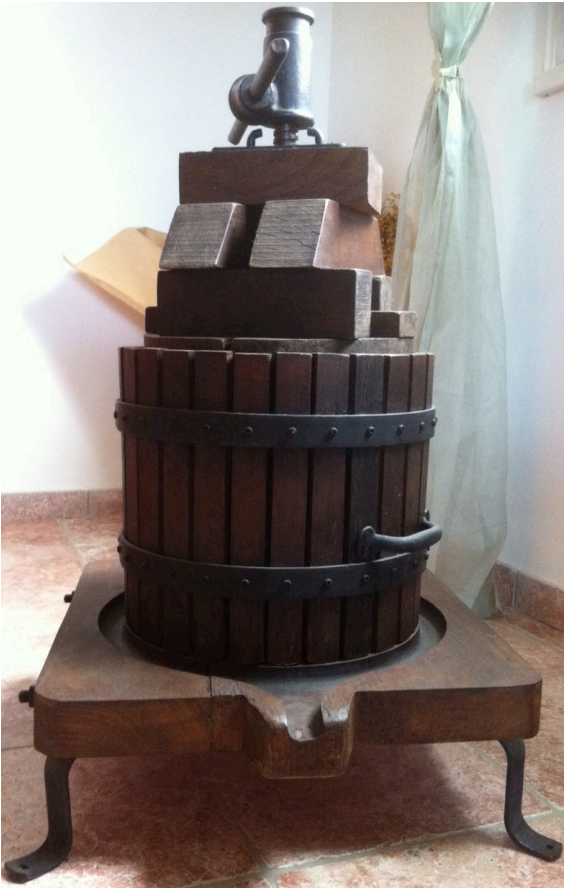
Figure 47 : presseur à vis en bois ( torchju, pressa )/ Isula Rossa
