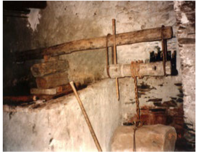
Figure 37: mécanisme de presse utilisé après foulage du raisin/ Photo Eddy Retali
