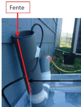
Écoulement de l'eau, variation de la hauteur d'eau dans le siphon en fonction du débit
