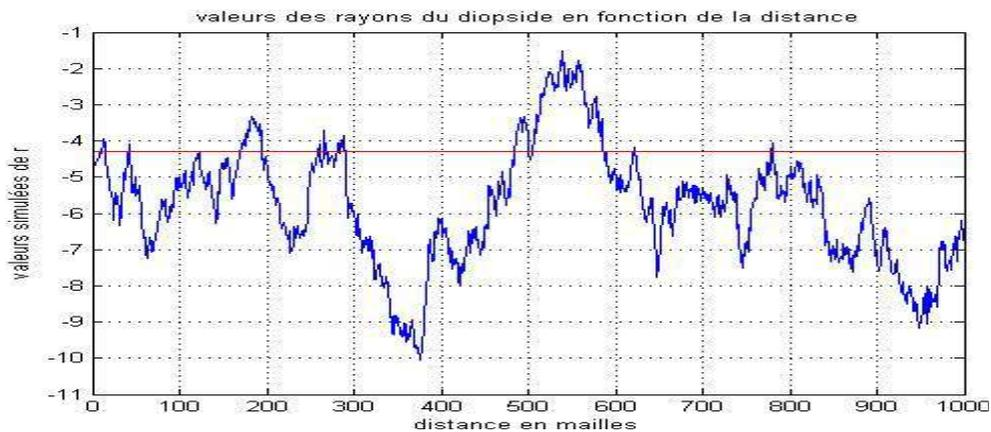
**Figure 18 : Valeurs simulées du rayon des grains (en échelle logarithmique) en fonction de la distance (mailles) avec une portée  $a=200m$**
